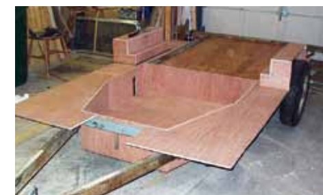
Golvet tar form. Notera fördjupningen för ökad takhöjd!
