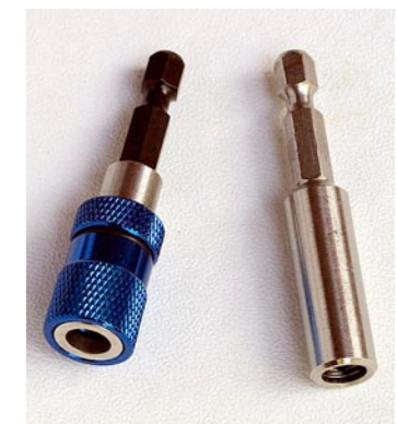
Bitshållare. Till höger en enkel hållare som håller kvar biten med enbart magnetkraft. Till vänster en variant från Clas Ohlson som dessutom kan ställa in hur djupt skruvarna ska dras i. Säljs i sats med sex bits för 98 kr.
