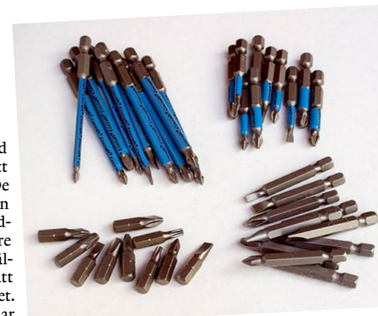
Bits. Överst två typer som gör att man kommer åt skruvarna i de djupa brunnar som de allt oftare dväljs i. 50 respektive 90 mm långa i sats om tio från Clas Ohlson för 98 kr styck. Nederst till vänster syns korta standardbits som ofta följer med maskinerna. Stoppa inte dessa i djupa bitshållare! Tag i stället den typ som syns till höger! Bitset är fynd från artikelförfattarens gömmor med numera okänt ursprung.
